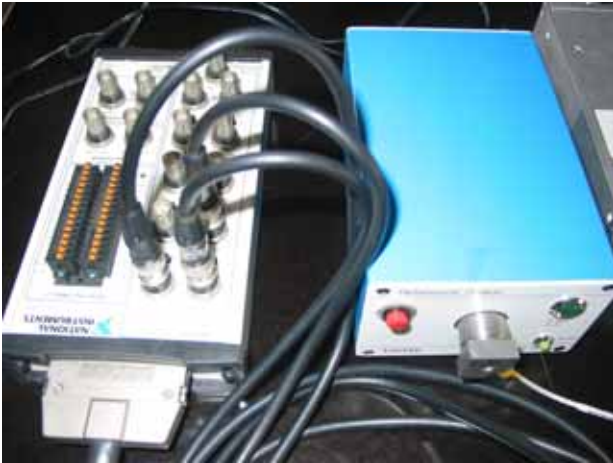
圖九則是加上加速規之電源供應器之情形，該設備不只是單純提供加束規所需要的電壓外，亦具有信號放大之效果。
